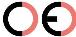
Falsche CE-Kennzeichnung (zu großer Zwischenraum)
